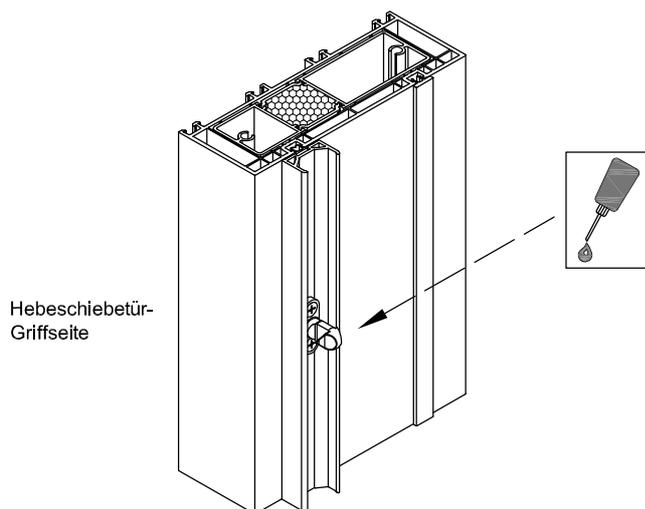
Reinigen Sie den Laufschienenbereich regelmäßig (staub- und schmutzfrei halten). Verwenden Sie für die Reinigung der Beschläge ausschließlich milde, ph-neutrale (keine aggressiven, säurehaltigen) Reinigungsmittel in verdünnter Form.
